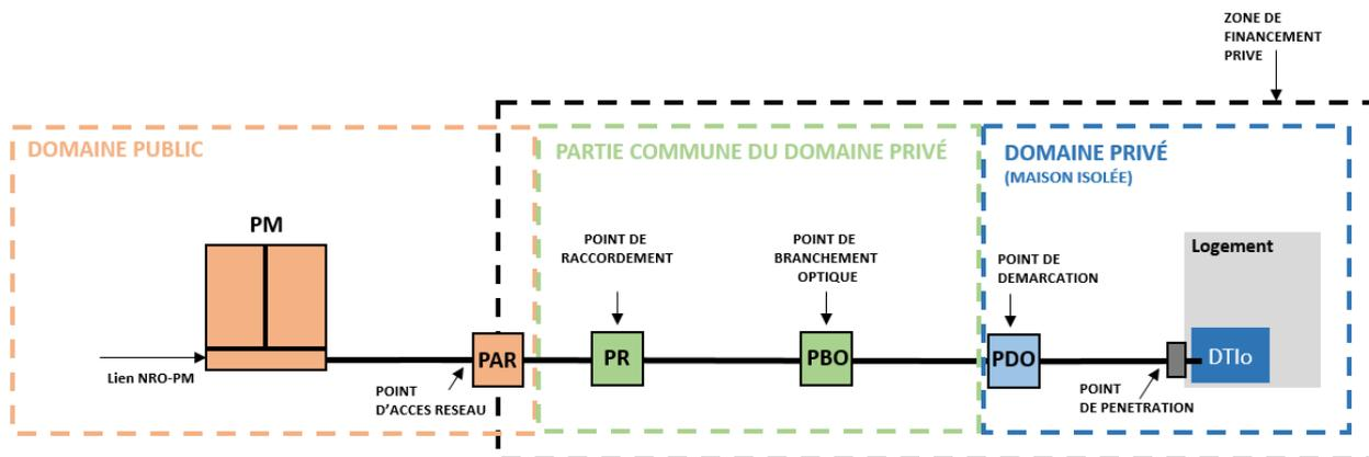
La prestation du Maître d'Ouvrage du lotissement commence au PAR (Point d'Accès Réseau) et s'arrête au DTIO dans chaque logement du lotissement. Le Maître d'Ouvrage se charge de l'adduction de la parcelle privée jusqu'au Point d'Accès Réseau (PAR) le plus proche.
